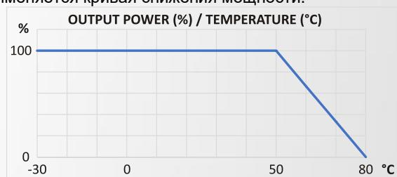
Таким образом, если зарядное устройство вынуждено работать при температуре выше + 50 ° C, оно просто снизит выходную мощность до соответствующего значения в приведенной выше таблице и продолжит нормальную работу.
